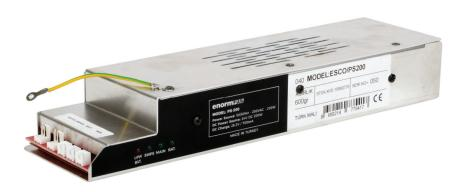
PS200, DOC 8/ 16 ile kullanılabilmesi için özel olarak tasarlanan bir power supply cihazıdır. 220V AC şebekesi ile beslenir ve çıkışı 24V, 8.5A olacak şekilde ayarlanmıştır. Sistem batarya tarafından da beslenebilir ve 24V 10A batarya girişi vardır. Kart üzerinde arıza halleri için durum ve uyarı ledleri bulunur. SMPS teknolojisi kullanılmıştır. Sistem, EN54-16 standartlarına uygun olarak tasarlanmıştır.
